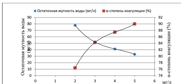
Рис. 1. Кривые эффективности степени коагуляции и снижения мутности воды.
